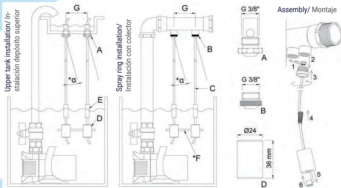
(\*)  $\alpha$  Max 15°. Use lace spacer/ Utilizar espaciador de hilo F
